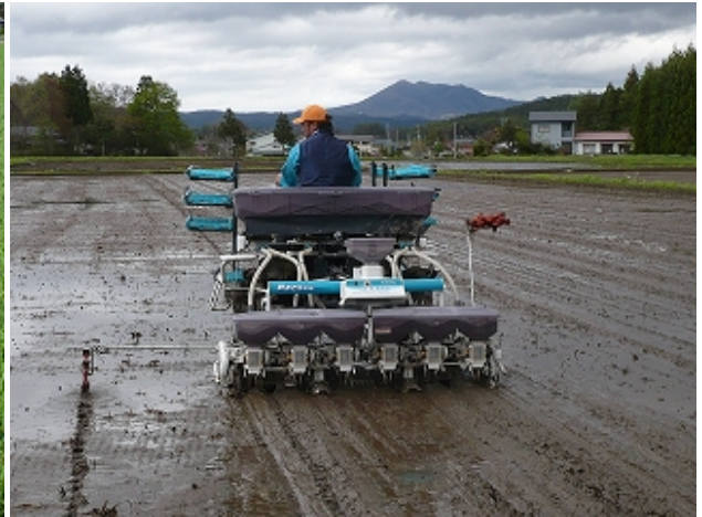
図2 鉄コーティング直播、播種作業の様子 (5月13日)
