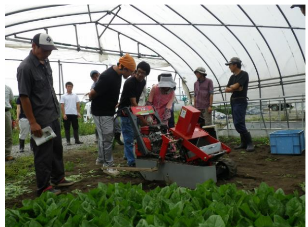
改良型の根切り機は、刃の向きが斜めになり使いやすいと高評価
