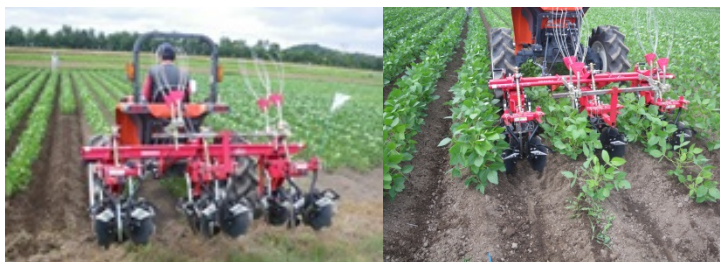
写真 1 改良型ディスク式中耕除草機
