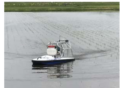
図3 ラジコンボートによる除草剤散布
