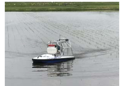
図3 ラジコンボートによる除草剤散布
