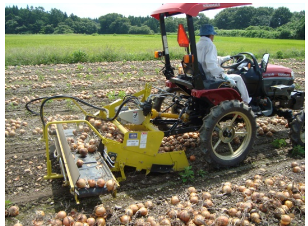
ディガーでピッカーの作業する畝を集約します
