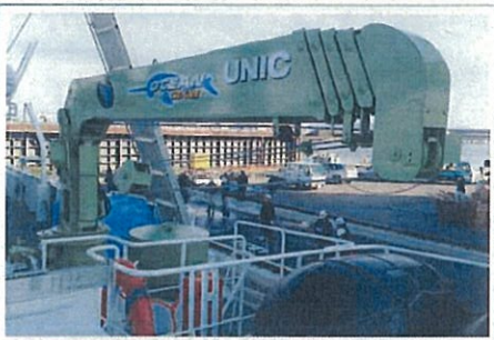
デッキクレーン
