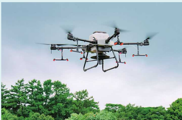
ドローンによる可変施肥（作物の生育や土壌などのばらつきに合わせて、農地の状況に応じた肥料散布を行うもの）
