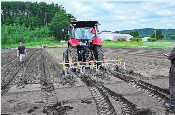
自動操舵トラクタを利用した機械除草
