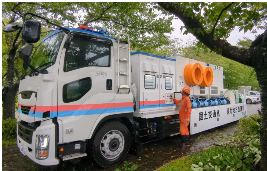
国土交通省による移動式排水ポンプ車の派遣支援の様子 (令和6年台風第5号による浸水被害が発生した宮古市田鎖地区)
