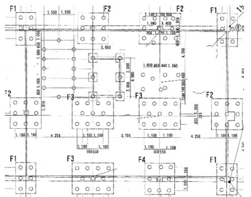
④ 従前機械棟 存置杭配置イメージ
