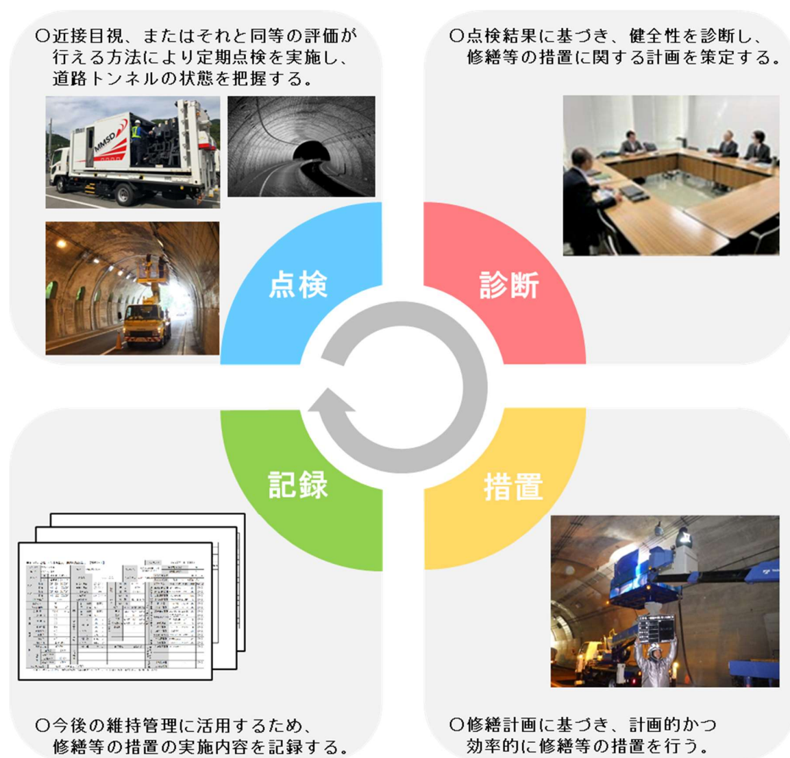
図 4-2 道路トンネルのメンテナンスサイクル
