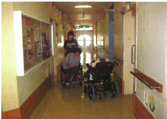
【廊下】 車椅子でのすれ違いが困難
