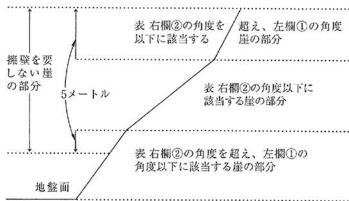
図 2-2 擁壁を要しない崖又は崖の部分 (2)
