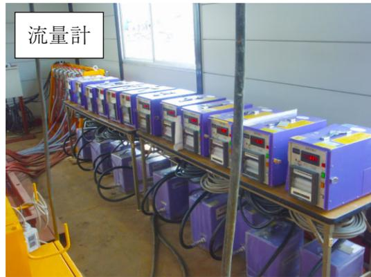
写真8 栄養剤注入用の流量計(12系統)
