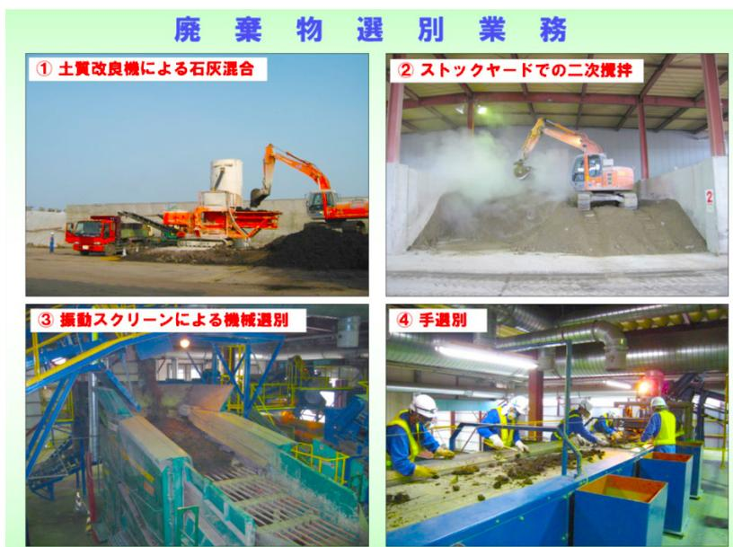
写真1 廃棄物への生石灰混合、機械選別、手選別の様子
