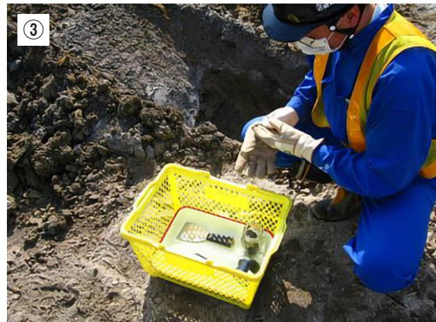
写真2 ①現場全体を覆うキャッピングシート、②廃棄物掘削完了目視確認及び③土壌分析試料採取の様子
