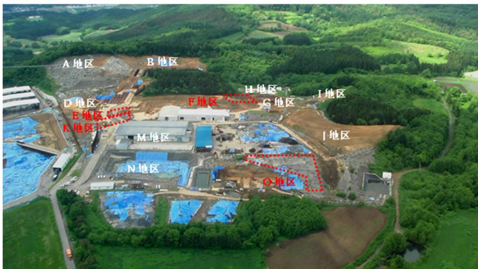
写真19 場内全景（赤：H24（2012）廃棄物掘削箇所 白：廃棄物掘削完了箇所）
