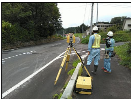
地上型レーザーキャナーによる 3次元現況計測
