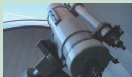
直径50センチの反射望遠鏡
