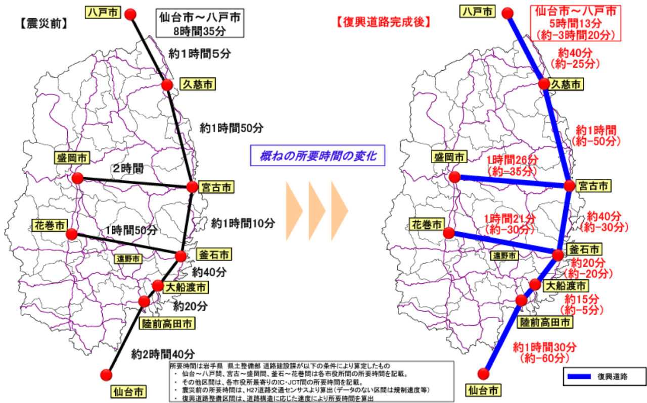
図 復興道路・復興支援道路の整備による時間短縮効果
