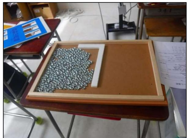
模型を使い、L型擁壁の仕組みを説明
