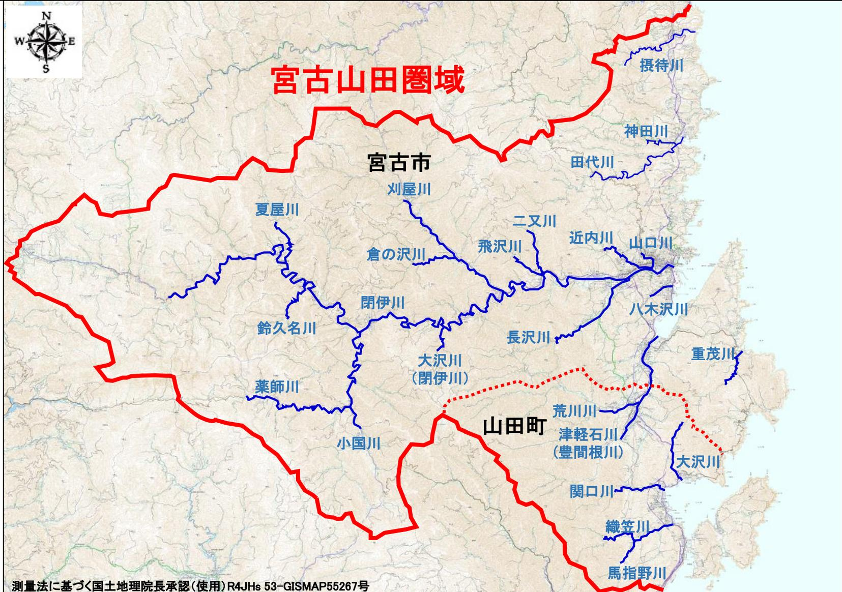
○平成28年台風10号、令和元年東日本台風では、各地で洪水が発生し甚大な被害が発生したことを踏まえ、宮古山田圏域において事前防災対策を進める必要があり、圏域内河川の河道掘削等により、洪水を安全に流すとともに、流域における砂防施設、治山施設、森林整備、道路の整備や避難のためのソフト対策に取り組み、流域が一体となり浸水被害の軽減を図る。
