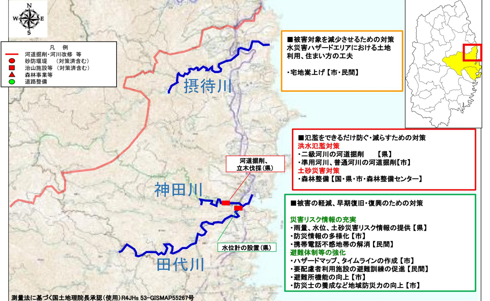
○平成28年台風10号、令和元年東日本台風では、各地で洪水が発生し甚大な被害が発生したことを踏まえ、宮古山田圏域において事前防災対策を進める必要があり、圏域内河川の河道掘削等により、洪水を安全に流すとともに、流域における砂防施設、治山施設、森林整備、道路の整備や避難のためのソフト対策に取り組み、流域が一体となり浸水被害の軽減を図る。
