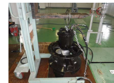
【農業集落排水施設のほつ気攪拌装置、汚泥引抜ポンプ】
