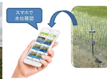
【基盤整備地区のスマート農業イメージ (トラクタの自動操舵、スマートフォンでの水位観測)】
