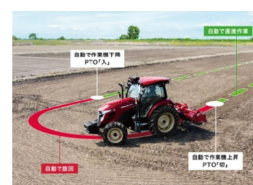
【基盤整備地区のスマート農業イメージ (トラクタの自動操舵、スマートフォンでの水位観測)】
