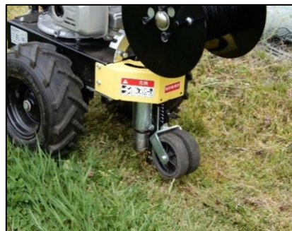
図4 エリアワイヤーの埋設
