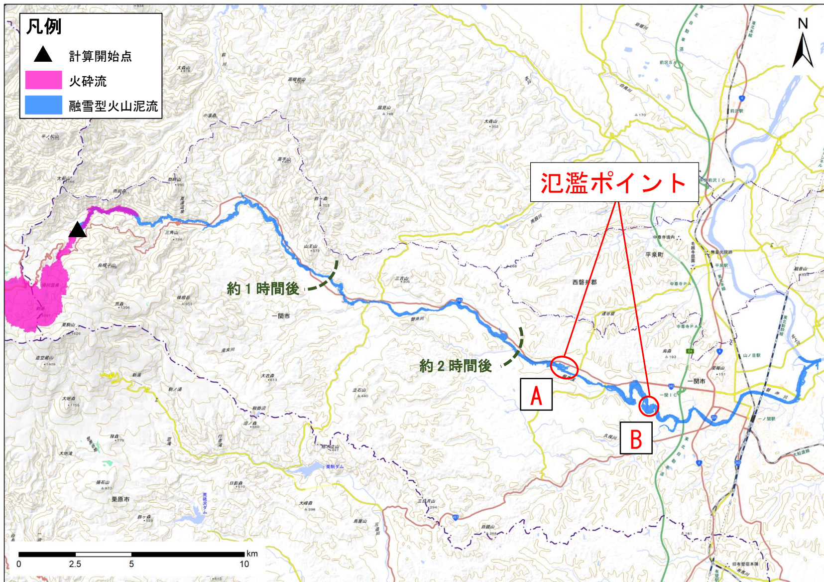
図 4-13 融雪型火山泥流シミュレーション結果
