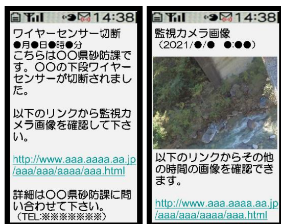
図 2-18 左：携帯電話への情報伝送イメージ 右：警報局イメージ
