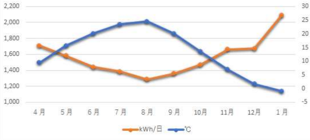
実質稼働日熱供給量 (kWh/d) と 喜多方市平均気温 (°C)
