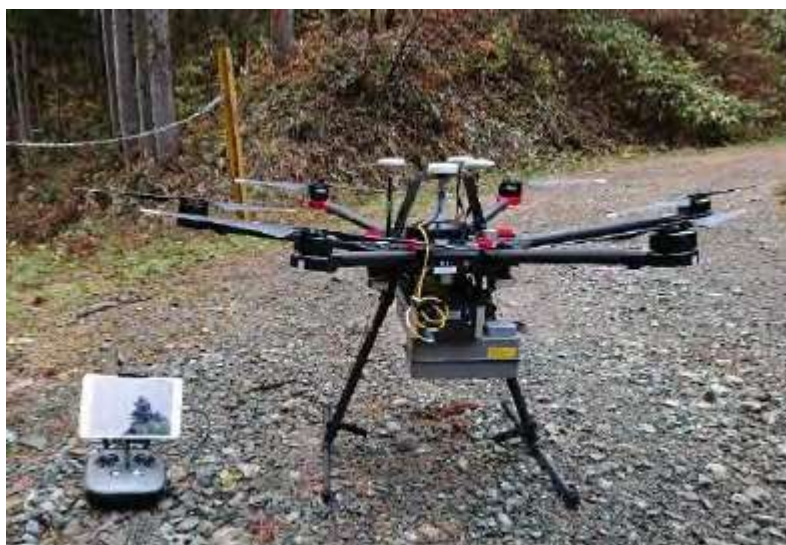
写真2 UAVレーザ測量に用いる機体
