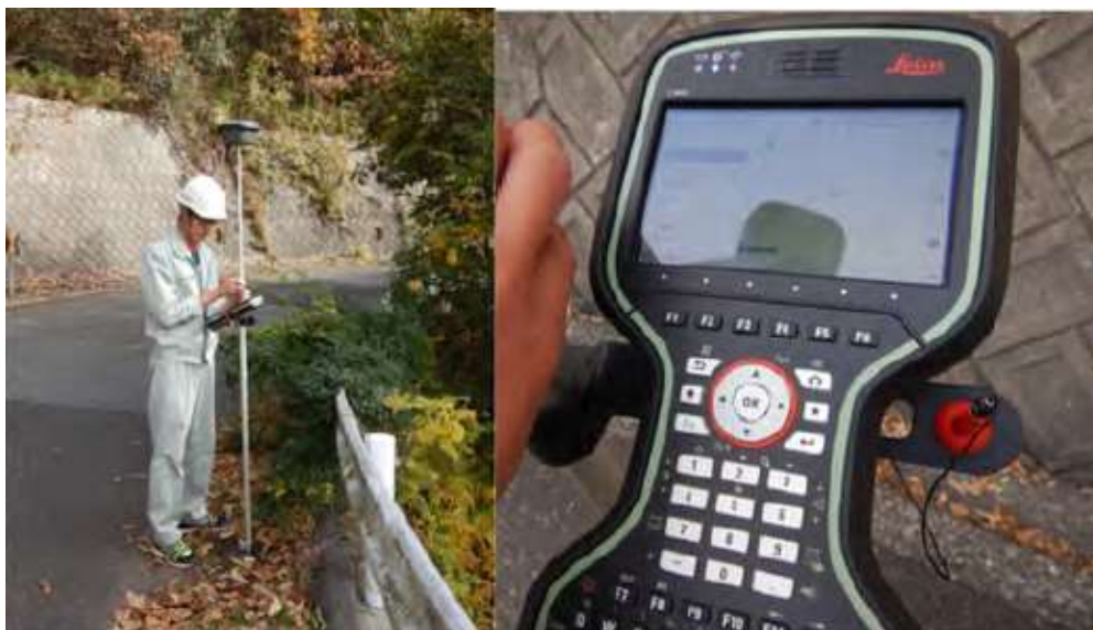
写真1 RTK-GNSS測位器による観測状況 (Leica 社 GS18T)
