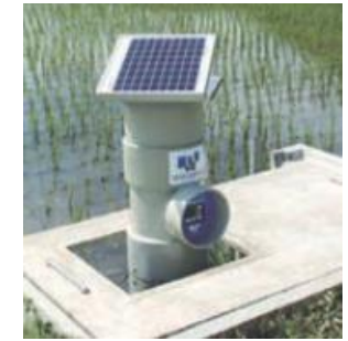
自動給水栓による水管理労力の低減
