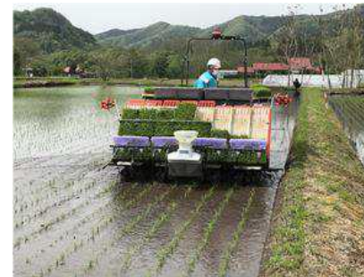
可変施肥田植機による施肥量の自動制御
