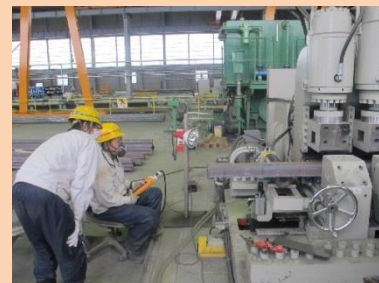
▲フレーム曲げ作業をしているところ
