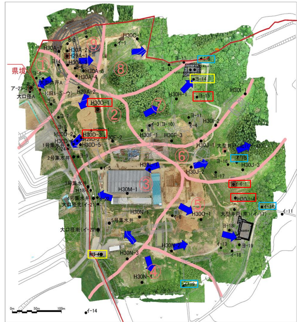
図4 薬剤処理工等の井戸配置図
