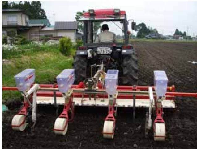
4条小畦立て播種機（ハロー耕幅300cm、条間75cm）
