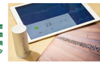
館内にセンサーを設置し、温度、湿度、CO2濃度を可視化。室内環境とエネルギーをモニタリング。
