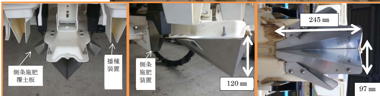
図1 開発した作溝装置（K社製鉄コーティング直播用点播機8条装着）
