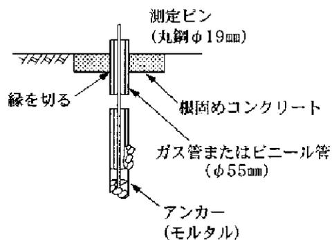
図 6-8 地中沈下測定点 of 設置例
