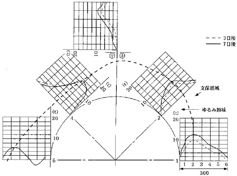
図 6-3 ロックボルトの軸力分布
