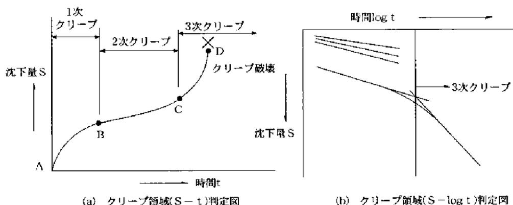
図5-1 天端沈下のクリープ領域判定図
