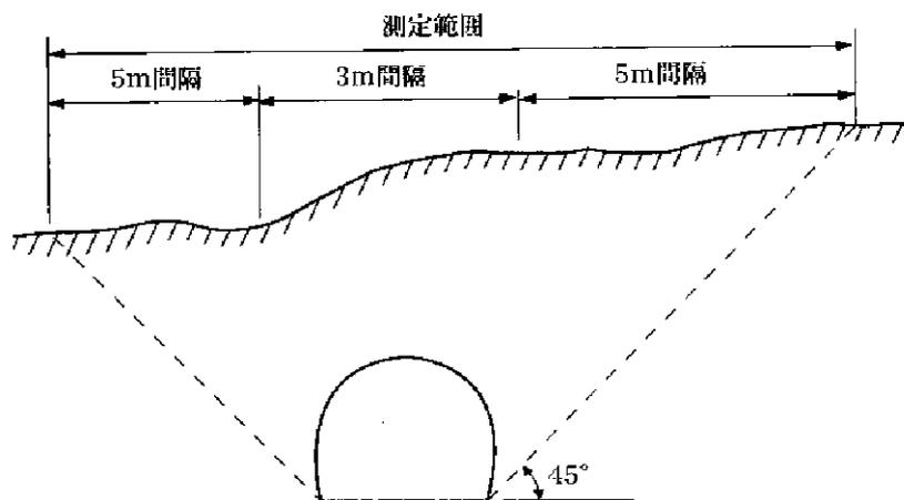
図 6-7 地表沈下の測定範囲及び間隔
