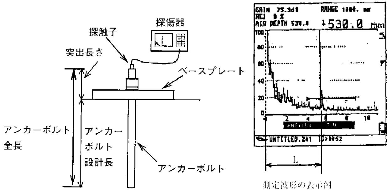
アンカーボルト長さの測定の例
