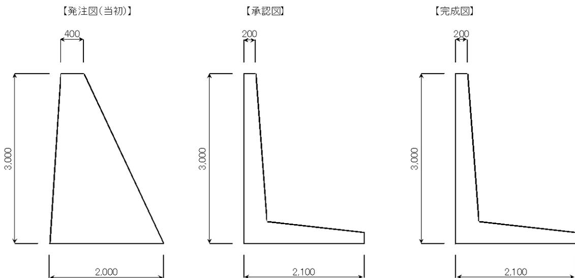
図 6-2 発注図及び承認図と完成図の関係
