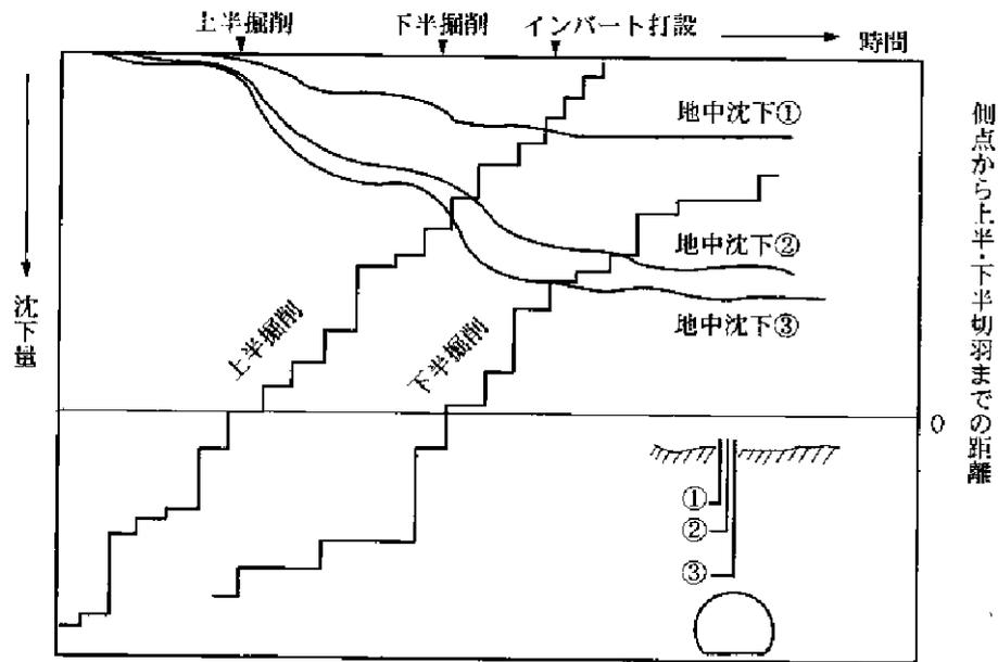
図 6-12 地表沈下量経時変化
