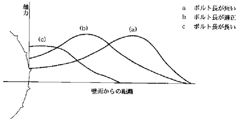
図 6-4 ロックボルトの軸力分布
