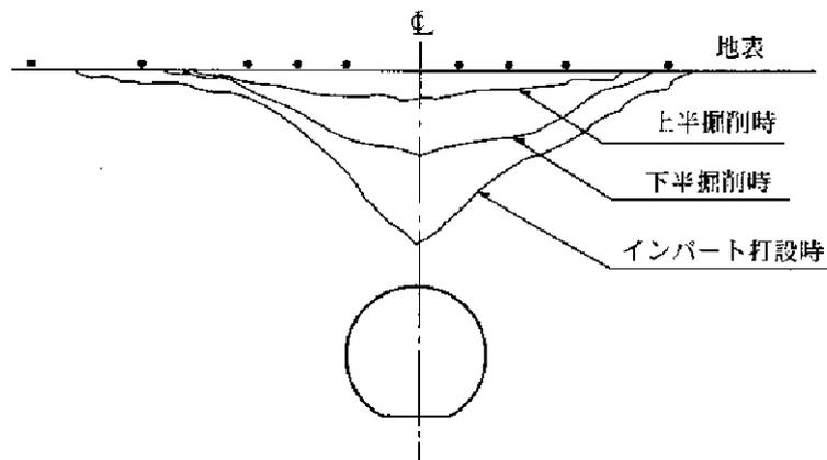
図 6-13 地中沈下分布 (横断方向)
