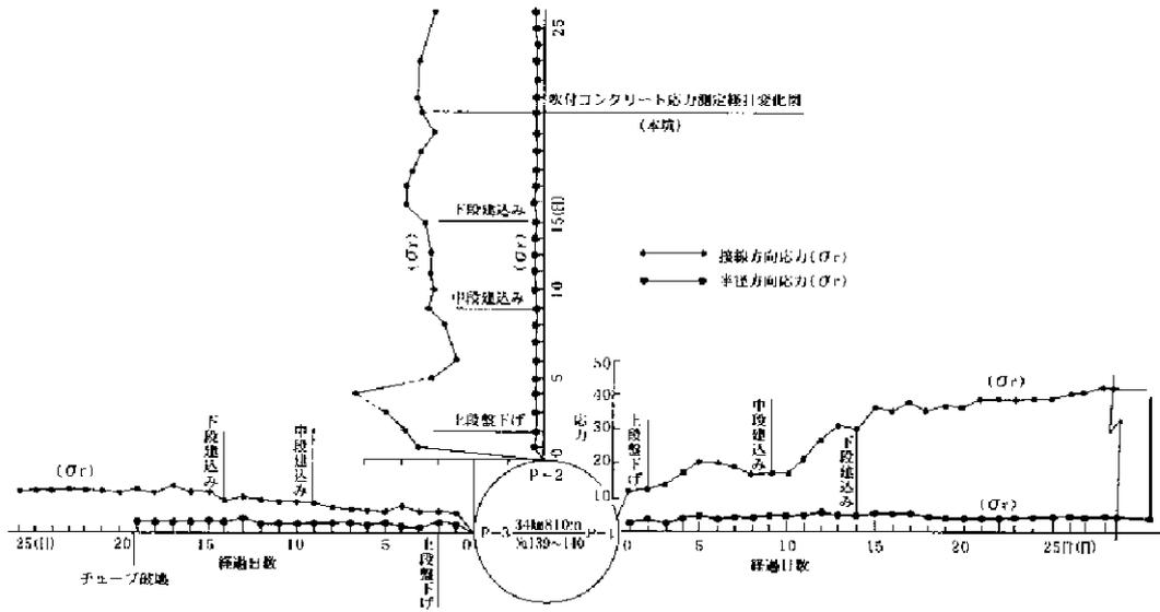
図 6-6 吹付コンクリート応力分布図
