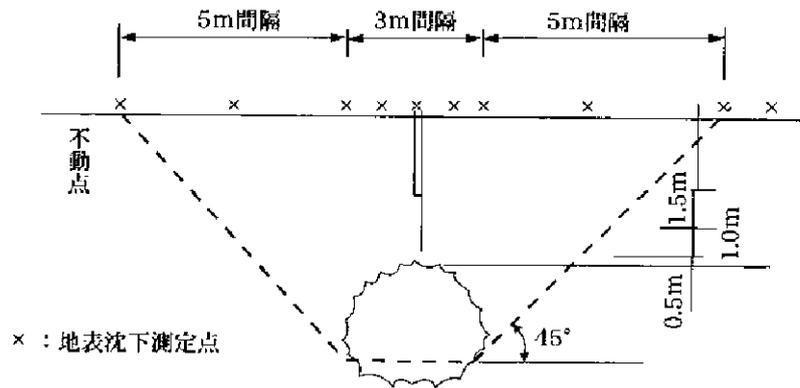
図 6-9 地中沈下測定点の設置例
