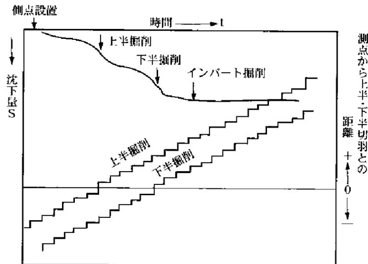
図 6-11 地表沈下量経時変化
