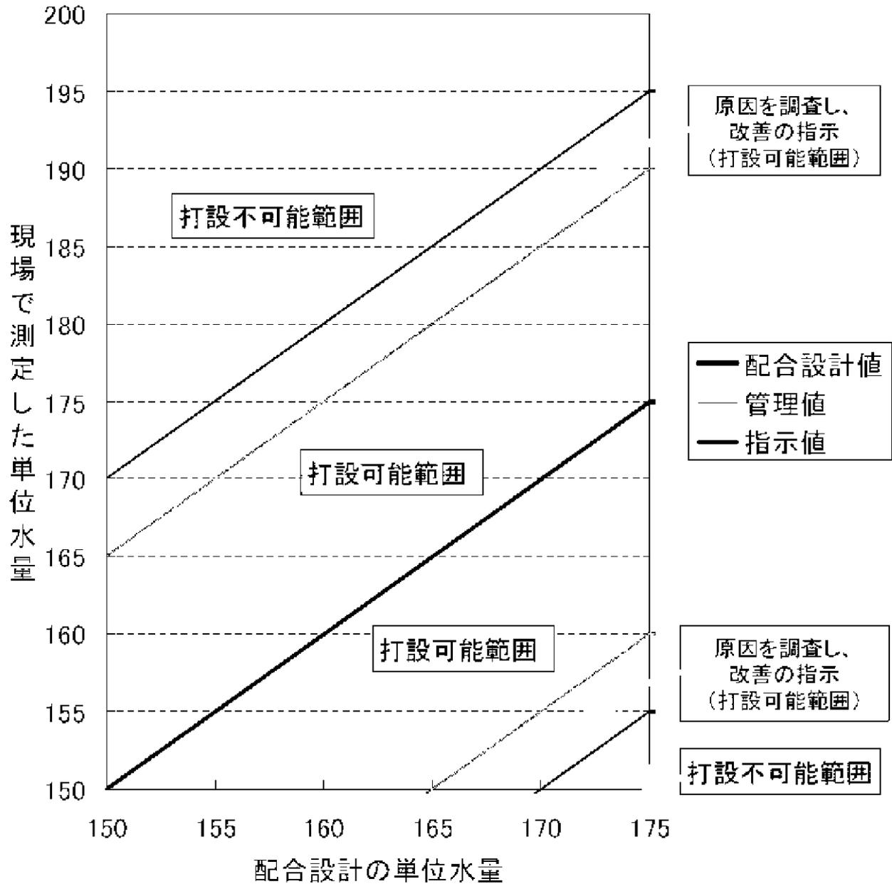
注) 単位水量の上限値が 175kg/m<sup>3</sup> の場合 (粗骨材最大寸法が 20~25mm)
