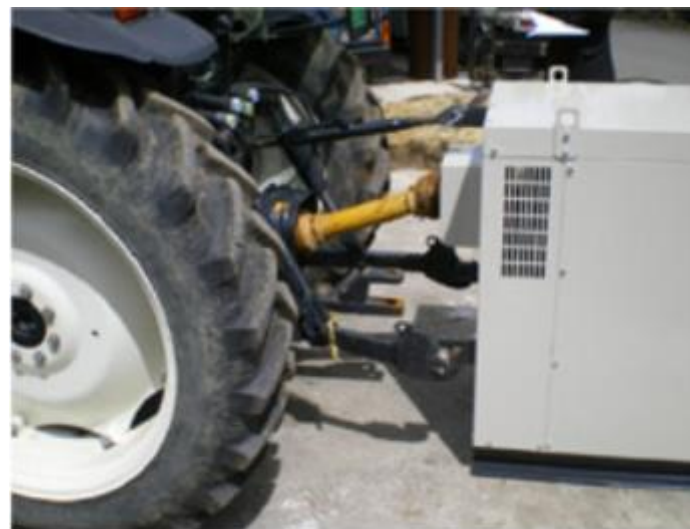
トラクタ P T O 駆動式発電機
