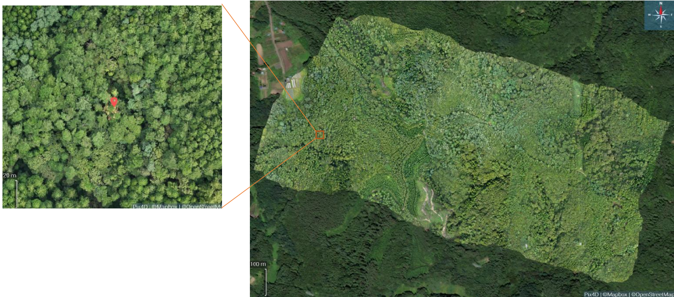
ドローン調査箇所のオルソ画像と松くい虫被害木の抽出
