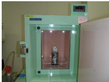
写真2 ゲルマニウム半導体検出器試料室
