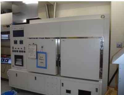
図8 大きな灰化炉でホタテ貝のむき身を灰にします
