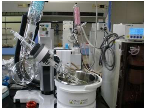
(写真2) エバポレーターによる濃縮作業
