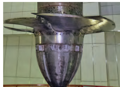
カプラン水車（四十四田発電所）
