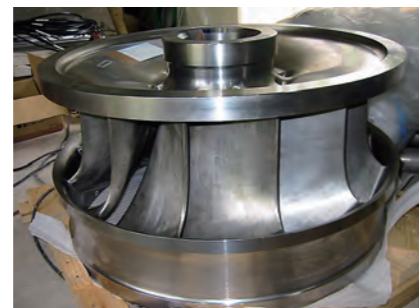
フランシス水車（柏台発電所）
