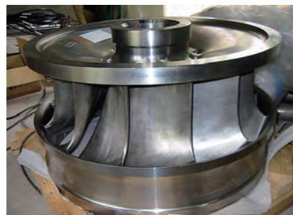
フランシス水車（柏台発電所）
