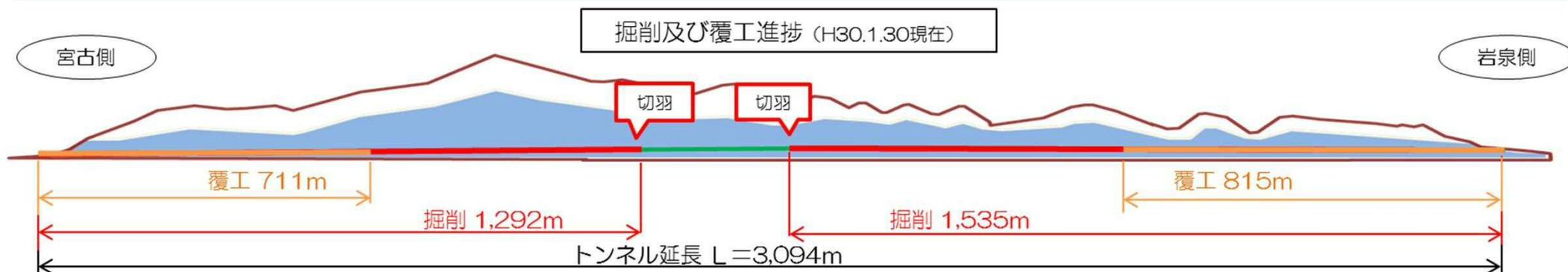
押角トンネルの掘削延長は、約2,827m（宮古側1,292m+岩泉側1,535m）で全長の約91%、覆工コンクリートは約1,526m（宮古側711m+岩泉側815m）で全長の約49%の作業が完了しています！
