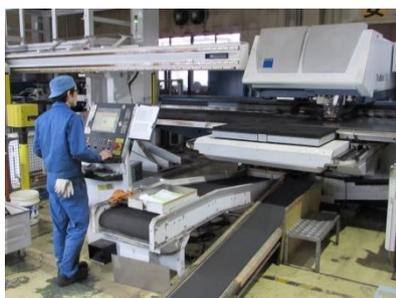
世界最速パンチ加工&レーザー発振機
