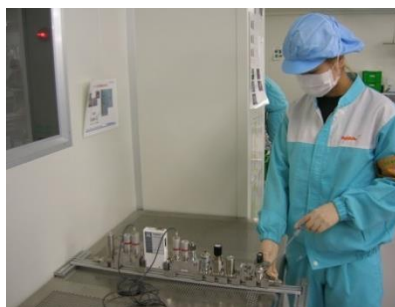
ガス供給システムの組立て
