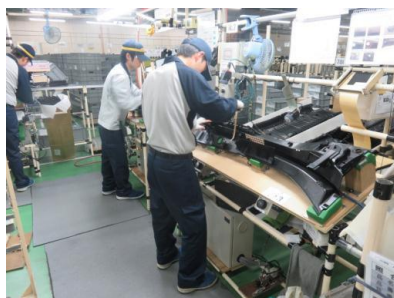
〔カウルルーバー組付工程〕
