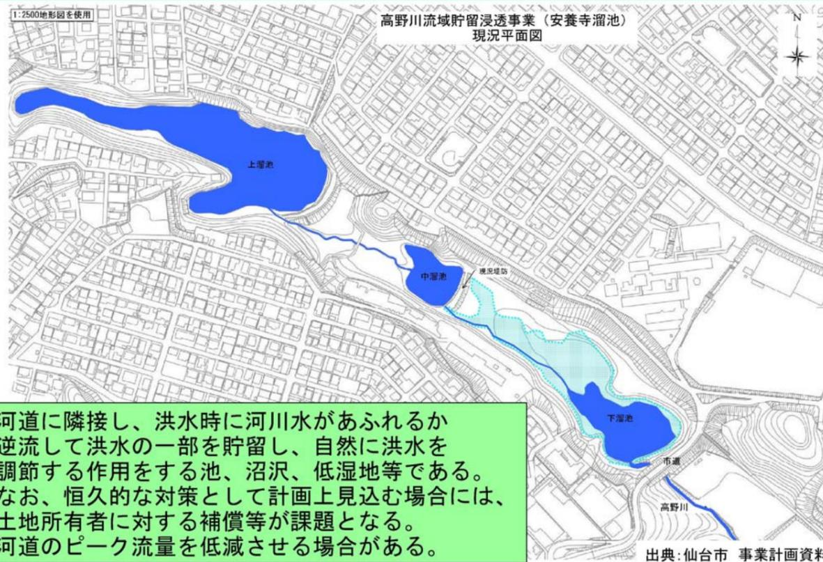
河道に隣接し、洪水時に河川水があふれるか逆流して洪水の一部を貯留し、自然に洪水を調節する作用をする池、沼沢、低湿地等である。なお、恒久的な対策として計画上見込む場合には、土地所有者に対する補償等が課題となる。河道のピーク流量を低減させる場合がある。
