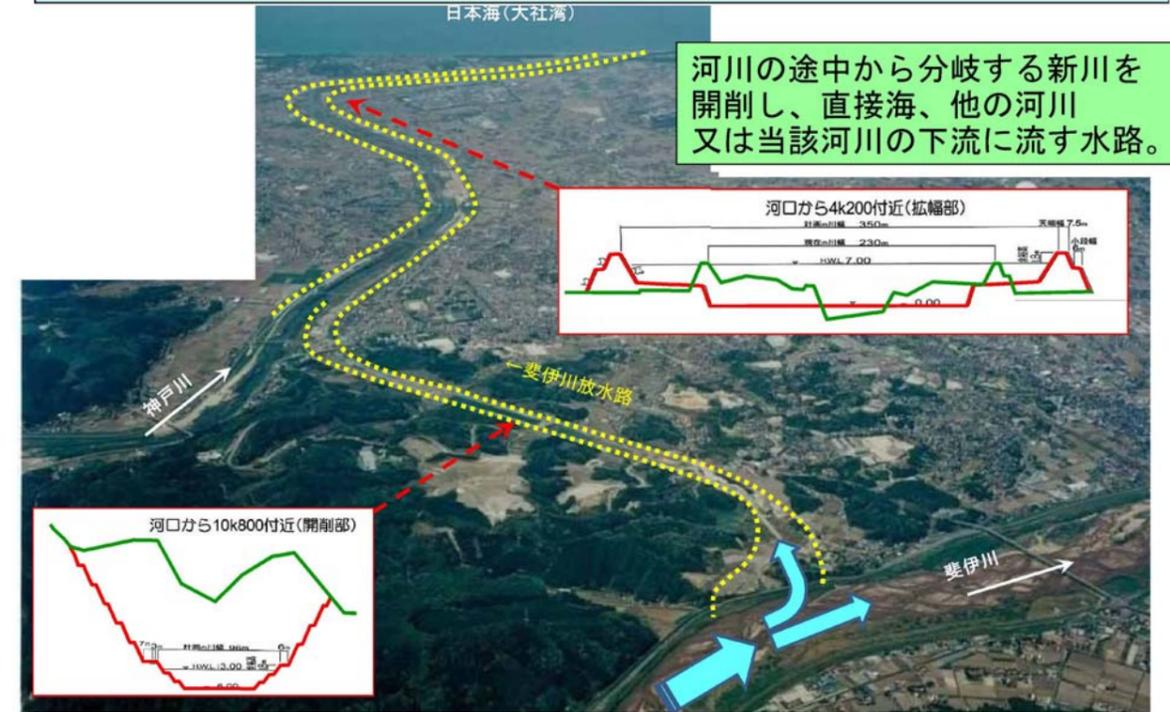
河川の途中から分岐する新川を開削し、直接海、他の河川又は当該河川の下流に流す水路。
