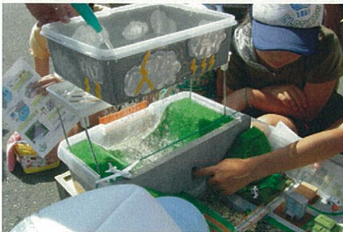
「ダム模型で実験」 降った雨がダムに貯まって、穴から少しずつ流すんだ
