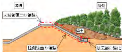
粘り強い海岸堤防(緑の防潮堤を含む)の整備
