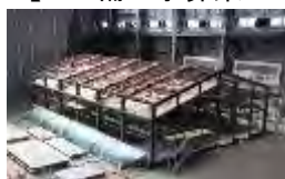
Eーディフェンスを活用した大規模な震動実験
