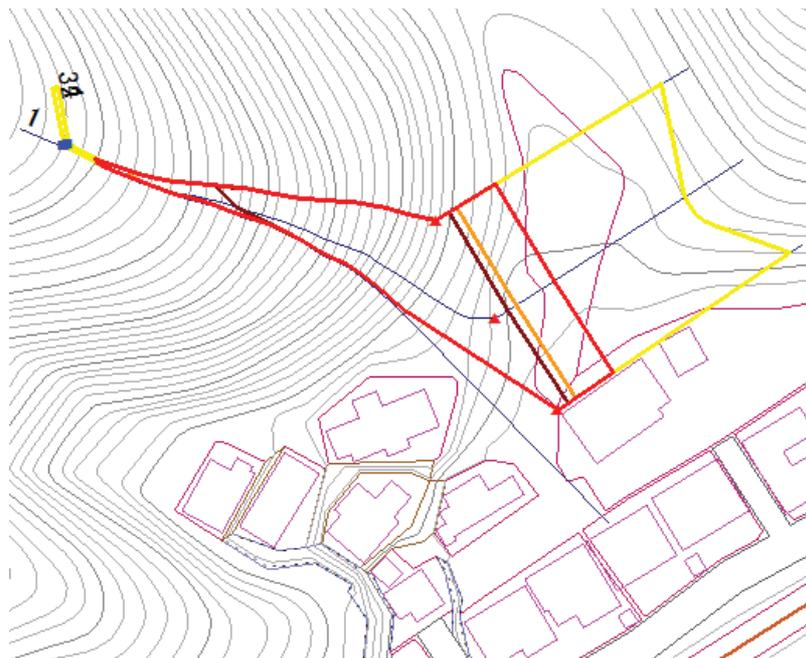
図 5.7 下端の延長方向の設定結果が地形状況と不適合になる事例
