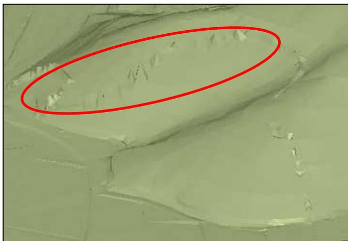
鳥瞰「ダリツク」表示による点検では、3次元地形モデルに異常が生じている場合、目視により確認することができる。
