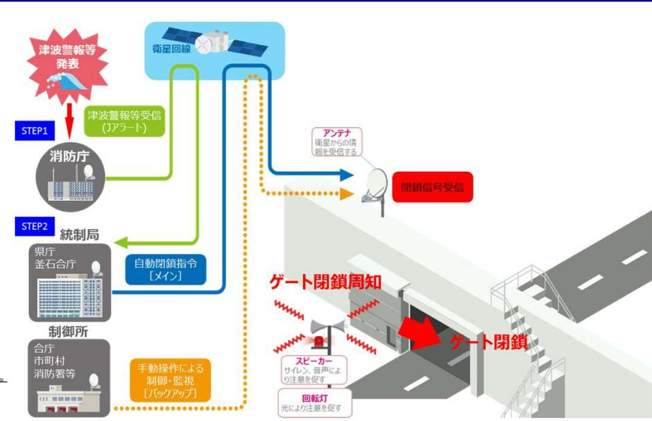
岩手県水門・陸閘自動閉鎖システムは、津波時に現地で人が操作することなく、災害に強い専用の衛星回線を使用し、安全かつ迅速・確実に水門・陸閘を閉鎖するためのシステムです。
