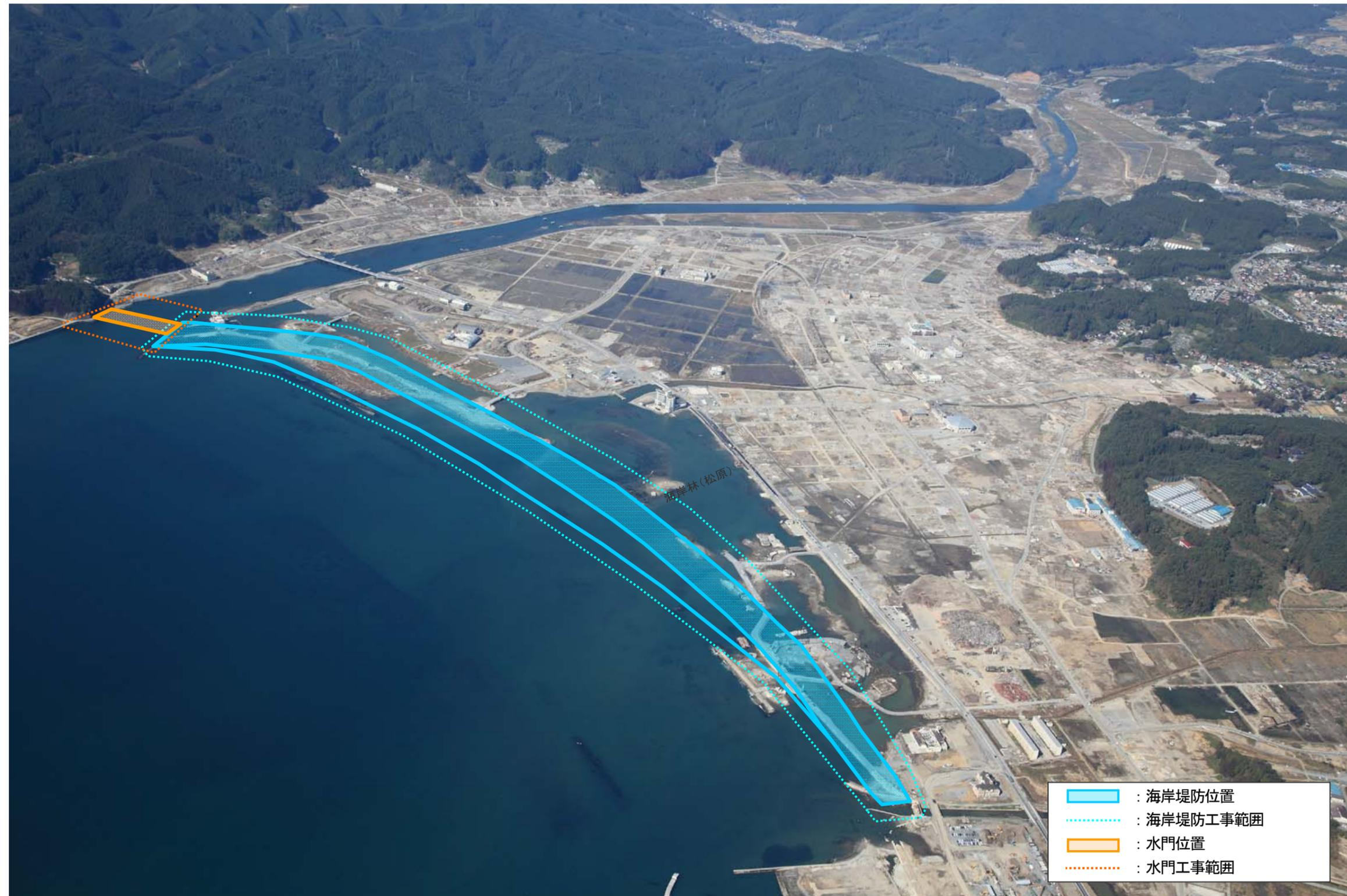
《施設整備後の見え方の比較》 【堤防】 現計画案：既存堤防と新設堤防の裏法尻で位置を合わせた場合（背後地への影響を極力抑えた場合）
