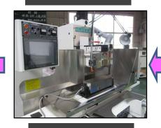
平面研削盤で加工
