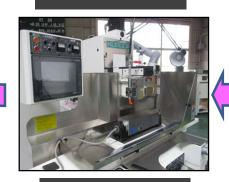
平面研削盤で加工
